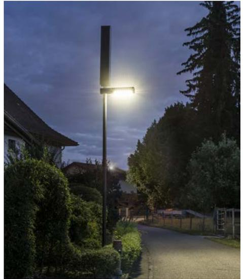
Die Solarleuchte besteht aus einem Kandelaber mit einem Lichtausleger und einer aufgesetzten Solarmodulbox, in der die Akkus und der Controller installiert sind.
