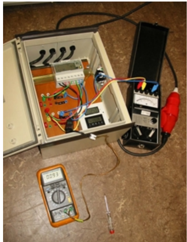
Fig. 3.2 Messausrüstung für Standby-Messungen (EMU 32 dreiphasig, umsteckbare Ein-/Ausgänge, Drehspul-Wattmeter, Stromzange/ Vielmessgerät)
