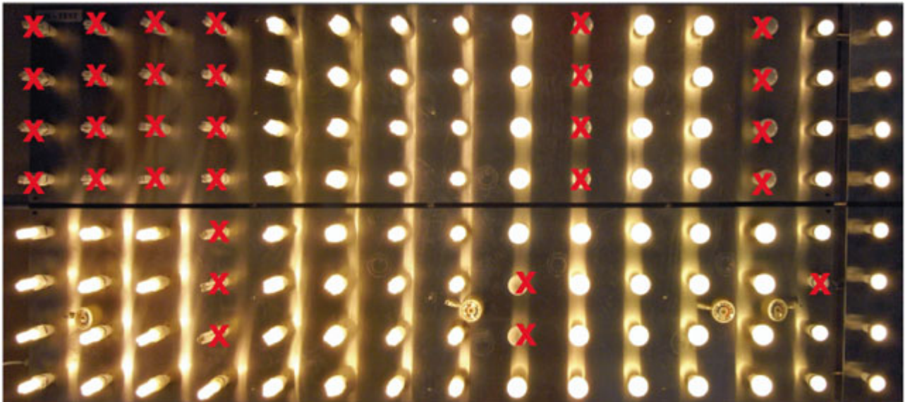
Abbildung 2: Lampenpanel mit 8 mal 15 Lampen (obere Hälfte: Lebensdauer, untere Hälfte: Schaltfestigkeit)
