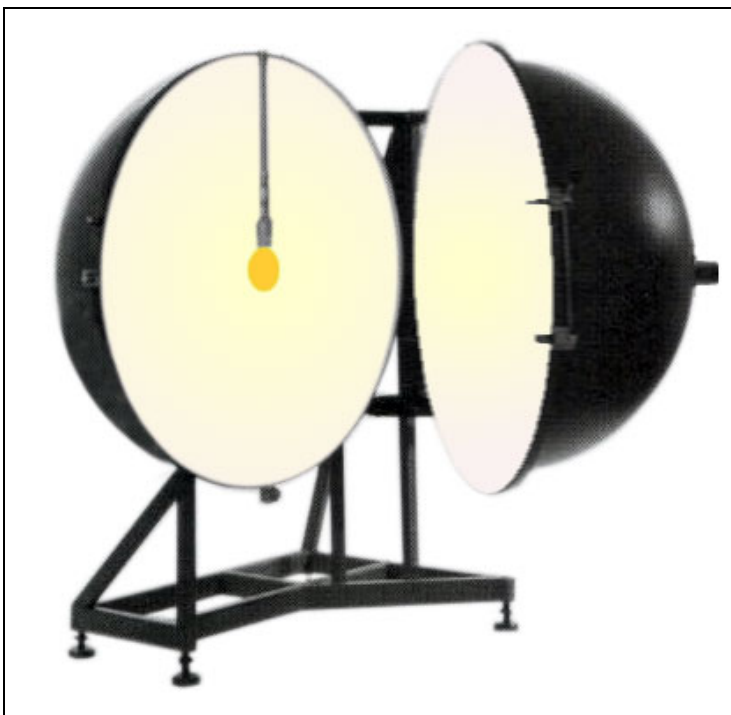
Abbildung 1: In der Ulbricht'schen Kugel werden Lichtstrom und Aufstartzeit gemessen
